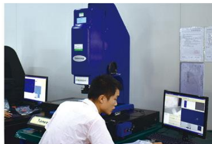
◆ 使用2次元检测中 Measuring with 2D projector
