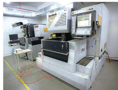
◆ 名称：线切割 WEDM ◆ 品牌：沙迪克SODICK ◆ 产地：日本 Made in Japan ◆ 加工精度：±0.005mm
