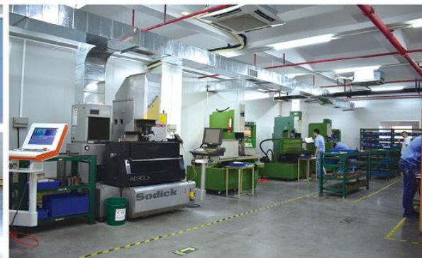
◆ 名称：CNC EDM ◆ 品牌：沙迪克SODICK ◆ 产地：日本 Made in Japan ◆ 加工精度：±0.005mm
