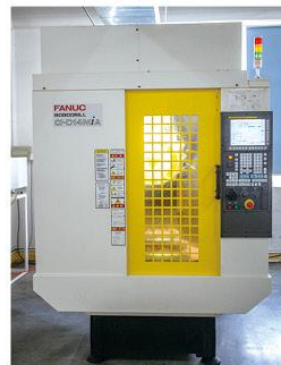
◆ 名称：CNC数控机床 CNC machine tool ◆ 品牌：发那科 FANUC ◆ 产地：日本 Made in Japan ◆ 加工精度：±0.005mm
