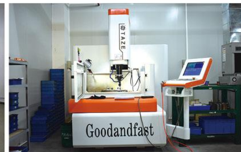
◆ 名称：CNC放电机 CNC EDM ◆ 品牌：台正 ◆ 产地：台湾 Made in TaiWan ◆ 加工精度：±0.005mm
